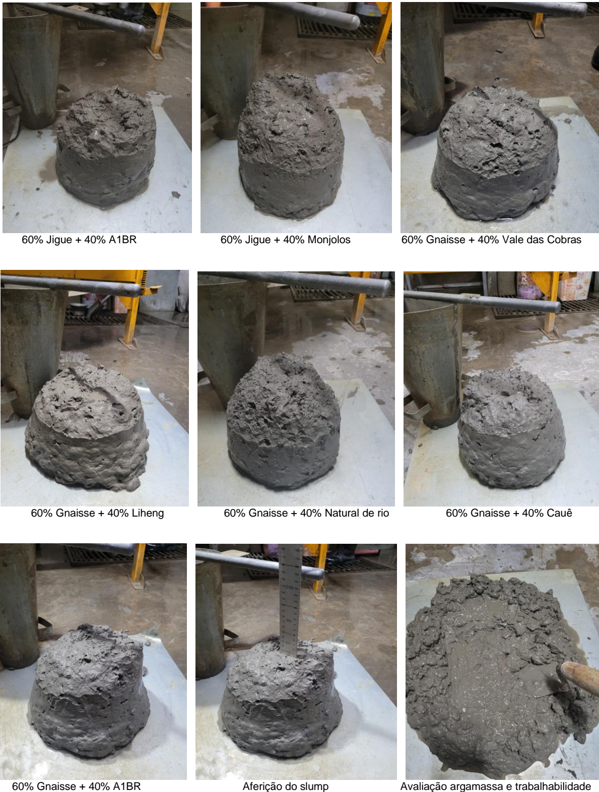
Figura 9 – Estado fresco das dosagens de concreto.
