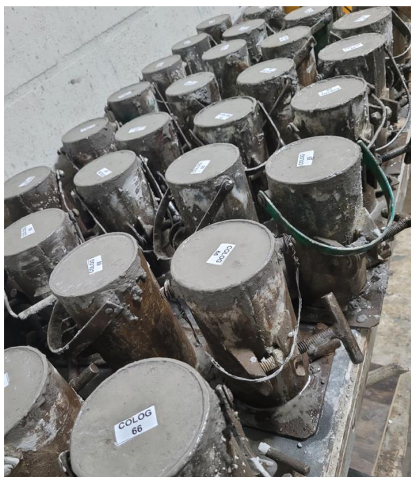
Figura 11 - Corpos de prova de concreto moldados e identificados.
