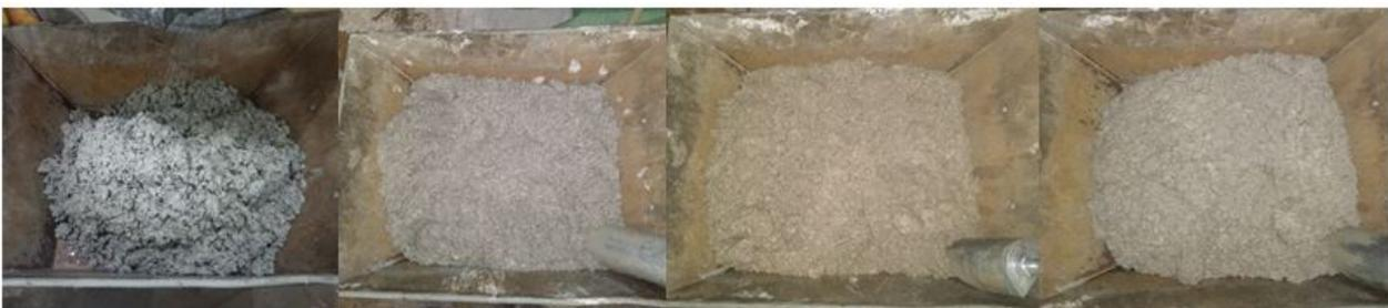
Figura 9 – Aspecto dos concretos com 52% de teor de argamassa. Da esquerda para a direita: Pó de pedra (Concreto 47), Areia da Mineração 1 (Concreto 48), Areia da Mineração 2 (Concreto 49), Areia da Mineração 3 (Concreto 50) (Autores, 2020).
